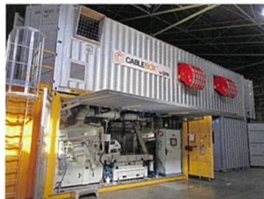
導入したMTB社製ナゲット機「ケーブルボックス」
